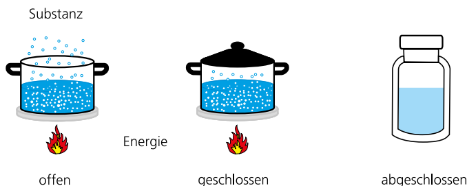
Abbildung 5.6: Der Begriff System in der Thermodynamik. Je nachdem, ob zwischen System und Umgebung Stoff- und Energieaustausch stattfindet, unterscheidet man zwischen offenen, geschlossenen und abgeschlossenen Systemen.
